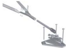
bsp. für einen fußpunkt, der an leichte setzungen des erdankerpunktes anpaßbar ist
