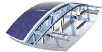
die konstruktion ist als biegesteife carbonstruktur konzipiert. auch der boden ist leicht gekrümmt und trägt zur aussteifung bei. die zugansprache ist aus dem mittelteil ausklappbar.
